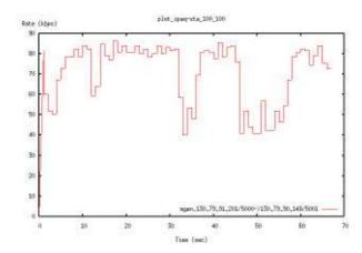
Après recherches, il s'agit du type de paquets employés qui pose problème : le type employé par défaut est DM1, qui permet un débit théorique maximum de 108kb/s. Forçons le type de paquet à DH5 (qui permet un débit théorique de 723kb/s en liaison asymétrique) avec la commande 'hcitool cpt <adresse de l'AP> DH5' (ce paramètre est aussi réglable dans le fichier hcid.conf). On observe maintenant un débit correct de 80kb/s.
