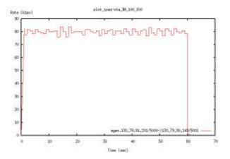
Lorsqu'on monte encore le débit à 100 paquets de 400 octets par seconde, on s'aperçoit que le lien sature à environ 120kb/s; cette vitesse correspond en fait à la vitesse d'horloge de la liaison avec le chip Bluetooth dans l'iPAQ.
